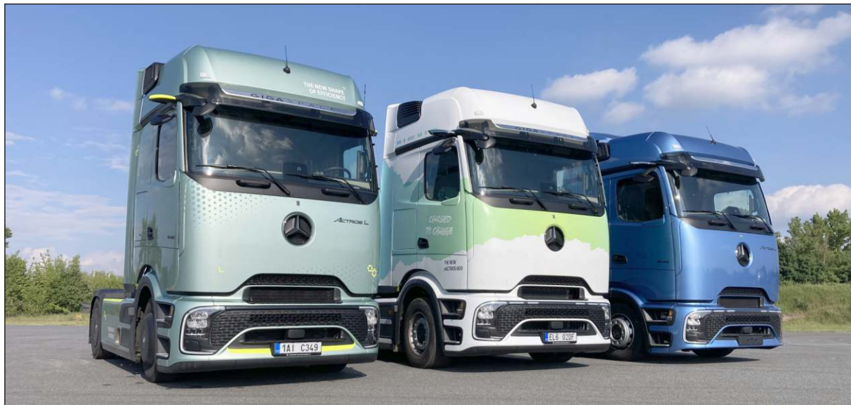
Nová kabina ProCabin je prozatím montována pouze na diesellové modely Actros L a elektrické eActros 600 (uprostřed)
